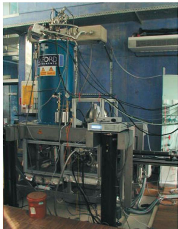
Abb. 1: Ansicht des Tieftemperatur-UHV-Tunnelmikroskops.
